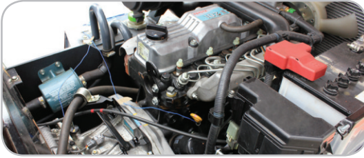
Toyota tork konvertörü ve otomatik şanzımanlı Toyota 1DZIII endüstriyel tip dizel motor (EU stage IIIa ile uyumlu)
