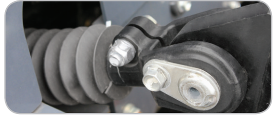
Dış alan koruması için tilt silindir körükleri hidrolik kol körükleri ve su geçirmez konektörler ile elektronik kontrol ünitesi
